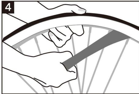
4 片側すべてのビードをリムからはずし、バルブ箇所を残して、チューブを取り出します。
