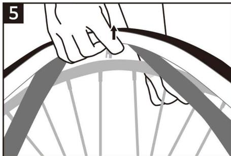
5 反対側のビードを外側へねじるようにしながらタイヤを持ち上げ、バルブ部分と一っしょにはずします。
