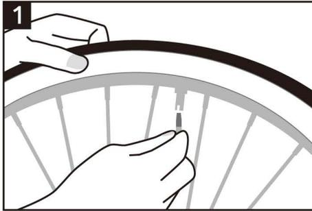
1 バルブのゴムキャップとナットをはずします。(空気が抜ける)
