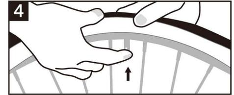
4 バルブを押し込んでください。この時、バルブ周辺のチューブをリムとタイヤビードの間にはさまないように注意してください。(タイヤビードを押ししてリムとの間を確認する)
